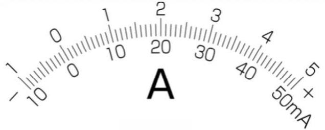
3. 500mA端子を使って電流を測ったら下図のようになった。電流の値を読み取りなさい。
